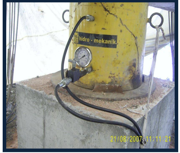
ARKAS HOLDİNG – AUTOPORT KÖPRÜSÜ TEST KİRİŞLERİNİN MONTAJI Ve YÜKLEME DENEYİ
